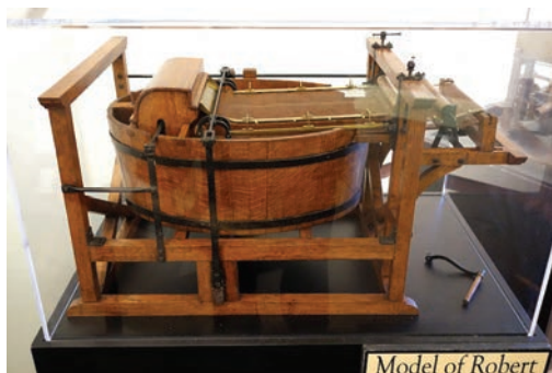
Сл. 1 Прва машина за производњу папира у бесконачној папирној траци (Robert Paper Machine 2014)
