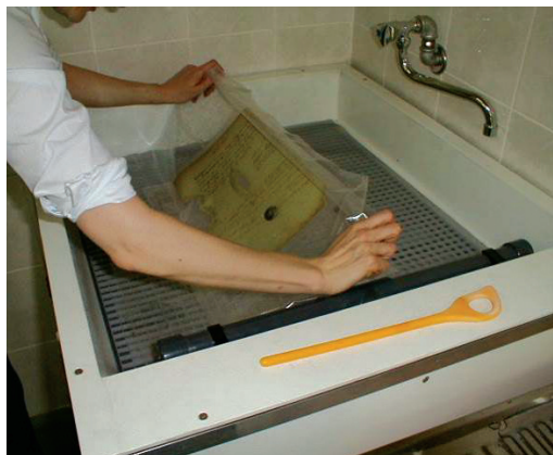
Сл. 3 Процес рестаурације машинским наливањем – постављање оштећеног папира у машину за наливање
