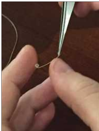
Израда ситних елемената за испуну од најтање жице: осмице, кружне овојнице (зог и чор)
