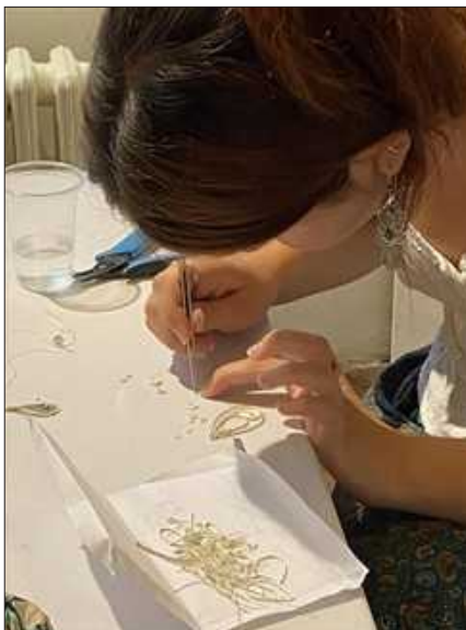
Израда ситних елемената за испуну од најтање жице: осмице, кружне овојнице (зог и чор)
